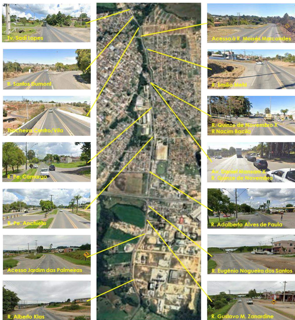
Figura 149: Configuração das Interseções em Nível da Rodovia-PR151.
