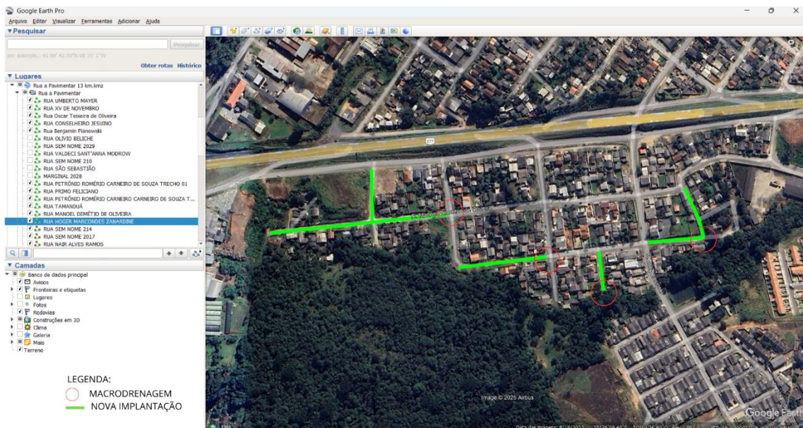
Imagem 01 - Implantação da nova drenagem conectando-se à macrodrenagem já existente
